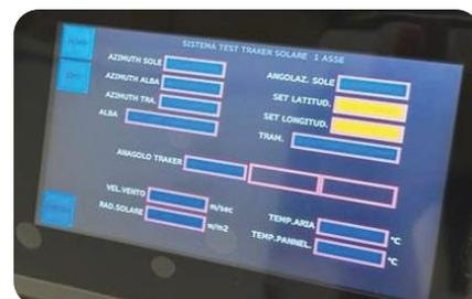
Grazie a sensori avanzati, regola dinamicamente l'orientamento dei pannelli solari in base alle condizioni atmosferiche. Il software programmabile offre flessibilità e controllo remoto, contribuendo alla massimizzazione dell'efficienza e alla sostenibilità dell'impianto.
