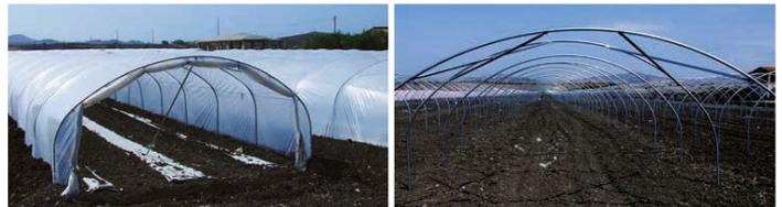
Archi leggeri per tunnel, realizzati con profilo a sezione trapezoidale o tubolare, facili da installare e versatili per ogni tipo di coltivazione a suolo. Garantiscono un buon compromesso tra resistenza ed economicità. Gli archi in lamiera zincata sono realizzati con spessori di 7/10 - 8/10 - 9/10 - 10/10 di millimetro a seconda delle esigenze del cliente. Le misure standard sono 4 metri e 5 metri, ma è possibile personalizzarle.
